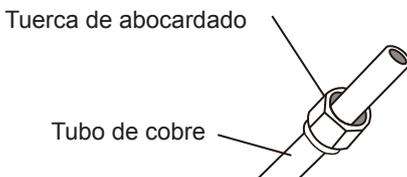
4. Retire la cinta de PVC de los extremos de la tubería cuando esté listo para realizar el abocardado.
