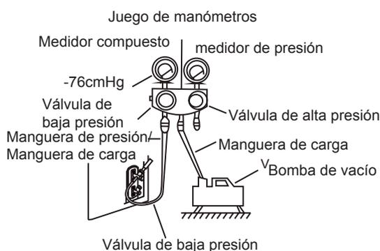
6. Cierre el lado de baja presión del manómetro y apague la bomba de vacío.
