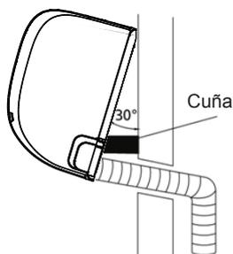
3. Conecte la manguera de drenaje y la tubería de refrigerante (consulte la sección **Conexión de la tubería de refrigerante** de este manual para obtener instrucciones).
