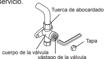
12. Usando una llave hexagonal, abra completamente las válvulas de alta y baja presión.
