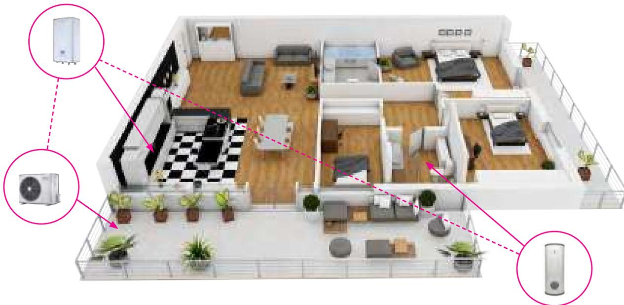
El conjunto M-Thermur A es la **solución modular multitarea** de la gama M-Thermal Arctic que aporta confort térmico en espacios de tamaño mediano y grande. Gracias a la posibilidad de impulsar agua hasta los 65°C, también con 5°C en el exterior, puede proporcionar calefacción a través de radiadores de alta eficiencia, fancoils, suelo radiante y acumular ACS a 60°C (70°C con apoyo solar o resistencias). Durante el verano será capaz de refrescar a través de los mismos terminales de calefacción\*.
